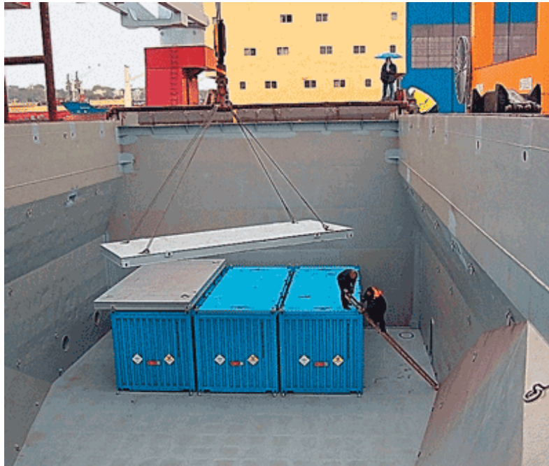
Рисунок 2 – Погрузка грузовых контейнеров в трюм
