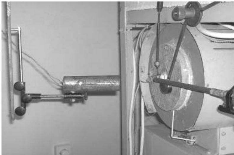
Рис. 2. Фрагмент експериментальної установки по визначенню воспламеняемости неподвижной (подвешенной) капли жидкого топлива в потоке воздуха
