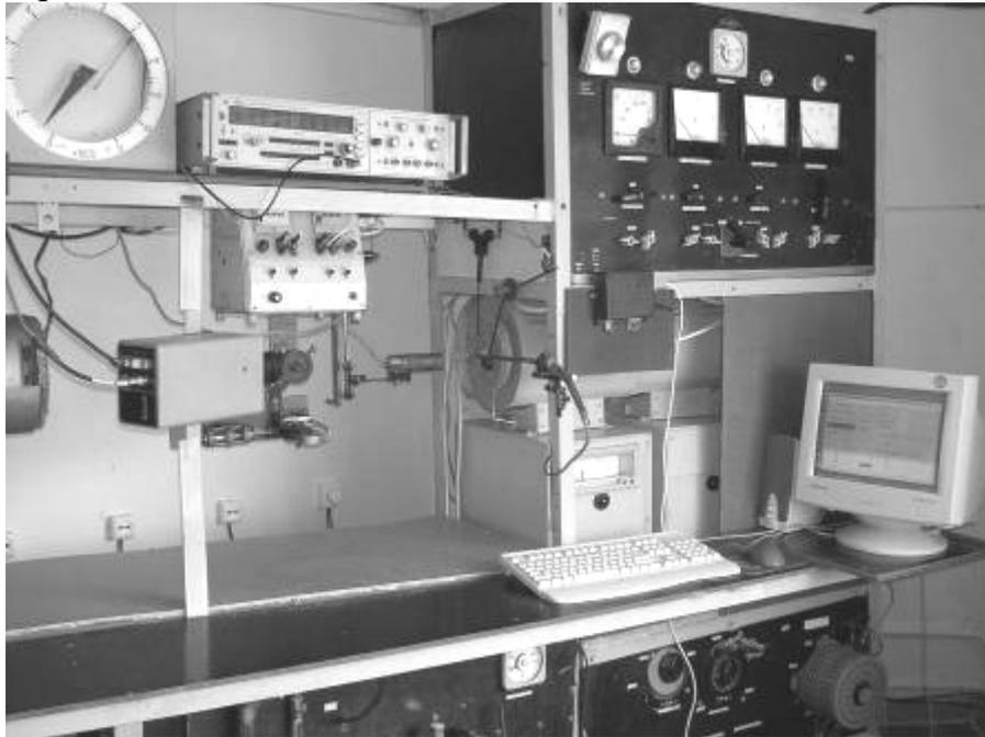
Рис. 1. Общий вид экспериментальной установки по определению воспламеняемости неподвижной (подвешенной) капли жидкого топлива в потоке воздуха
